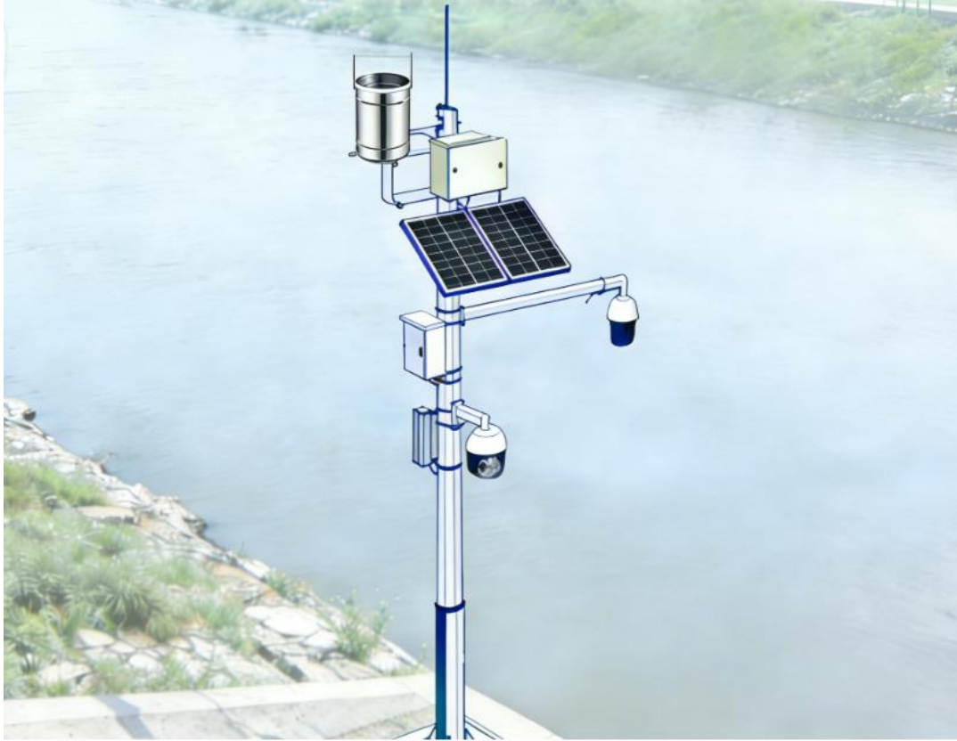
图 2.1-6 山洪水位-视频监控与预警站-安装示意图
